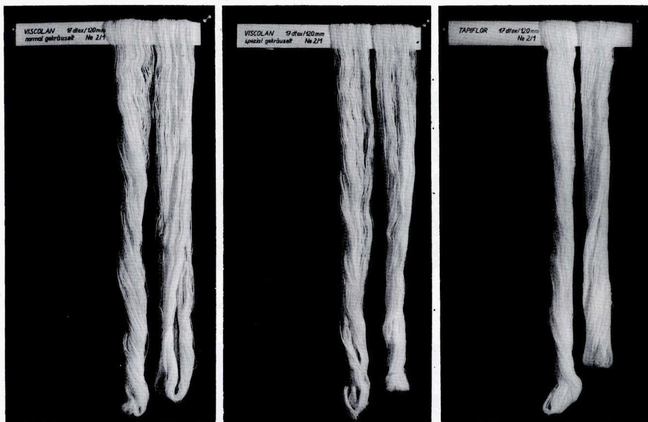
Abb. 6: Darstellung des Längenänderungsverhaltens von Garnen aus Viscolan ® , aus Viscolan ® - spezial gekräuselt und aus TAPIFLOR ®
