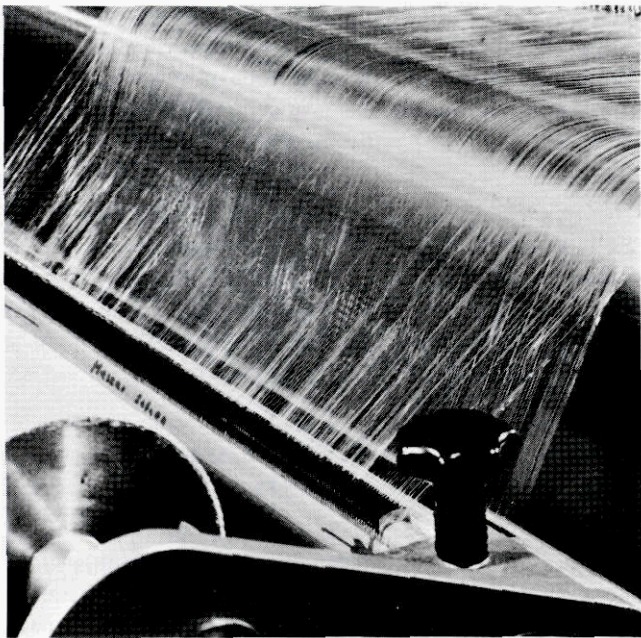
Abb. 2: Doppelter Folienablaß und Split-Weaving-Einrichtung
