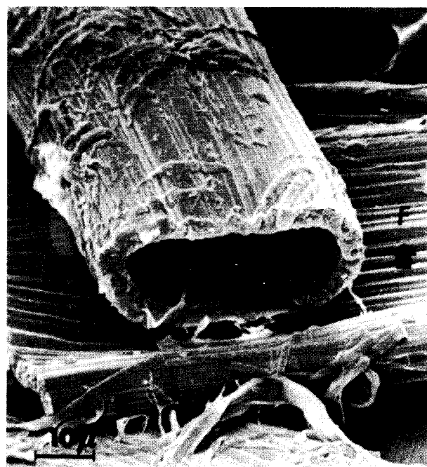
Abb. 6: Starke Schrumpfungsfalten (F) einer Viskosehohlfaser bei Magnesiumsulfatzusätzen zum Spinnbad
