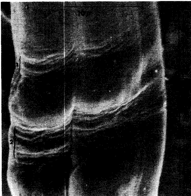
Abb. 7: Klemmspuren an einer Rayon-Einzelfaser nach dem Einspannen im Festigkeitsprüfgerät
