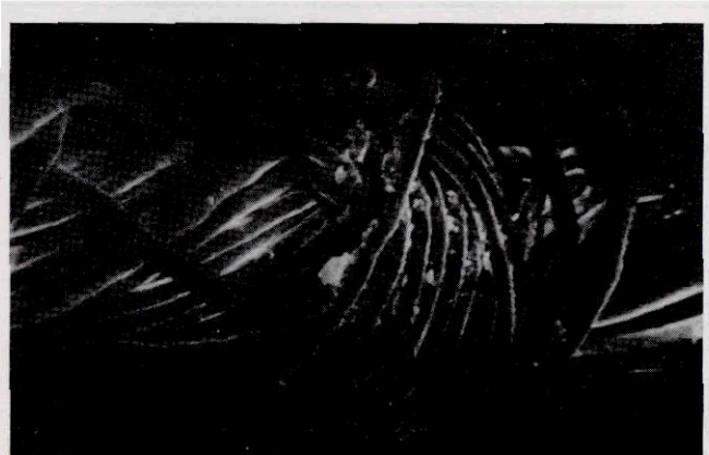
Abb. 1: „Bauchbinde“ bei Rotorgarn (Stereoscan-Aufnahme)
