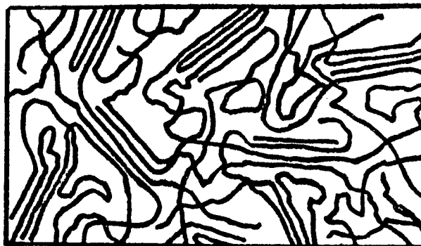
Abb. 5: Ebene Schemadarstellung der Verhängung kristalliner und nichtkristalliner Bereiche
